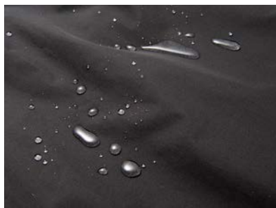
水が瞬時に玉になってずると滑るのは強い撥水機能が発揮されている証拠。
